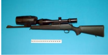
Abbildung 1: Im Kanton Aargau wurde das Nachtzielgerät Nitespot 50 (Vectronix) in einer Pilotstudie für Wildschweinabschüsse eingesetzt (Foto: Sektion Jagd und Fischerei Kanton Aargau).
