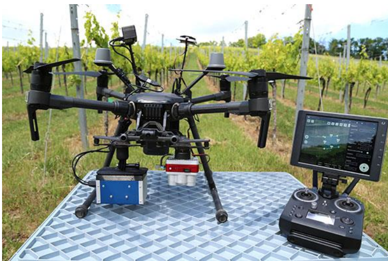
Abbildung 3: Das UAV DJI Matrice 210 V2 RTK mit den Multispektralkameras Tetracam Macaw (links) und MicaSense Altum (rechts) sowie Fernsteuerung mit Tablet
