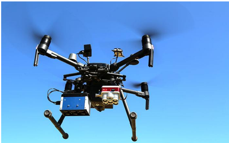
Abbildung 1: Multispektralkamera an einem UAV (unbemanntes Luftfahrzeug)
